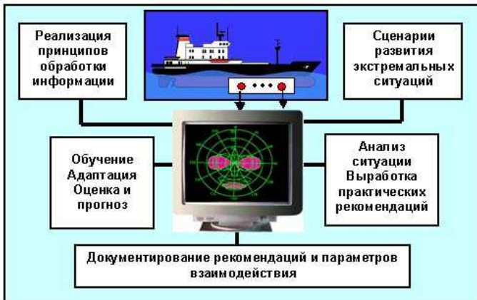
Рис. 1. Архитектура интегрированной бортовой ИС
