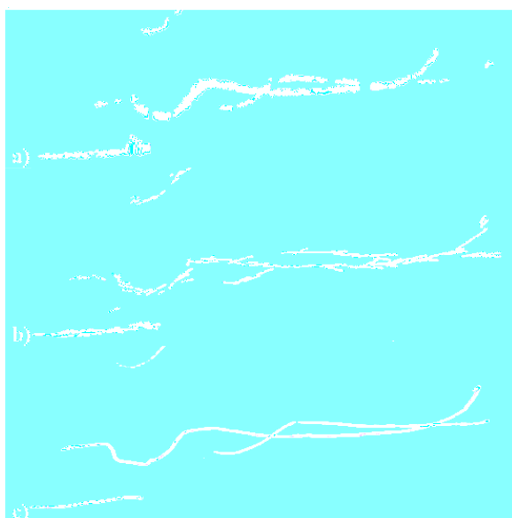
Рис. 15. Этапы обработки ионограммы: (а) клеточный автомат убрал вертикальные помехи и заполнил пропущенные отсчеты; (б) инициализация роторов путем углового гистограммирования в скользящем окне переменного размера в зависимости от изменения кривизны трека; (с) результат распознавания
