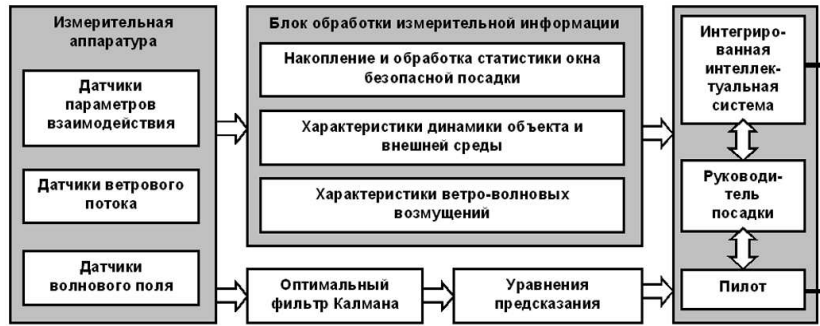
Рис. 7. Блок-схема обработки информации о состоянии внешней среды и поведении ДО на волнении
