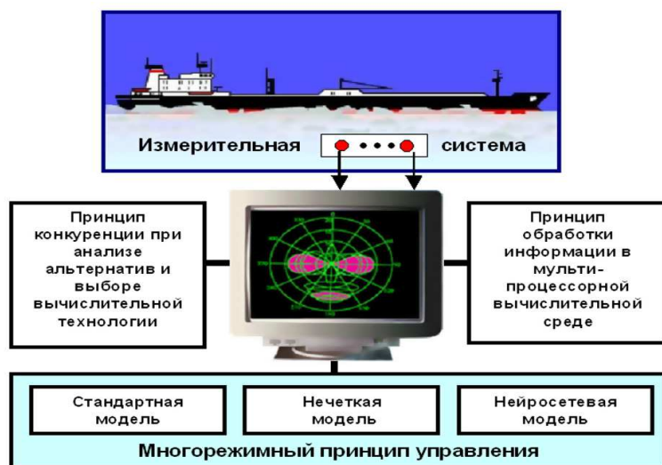
Рис. 1. Общая схема функционирования системы контроля прочности
