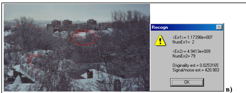
Рис.5.3. Варианты автоматического выделения заранее определенной детали дома на фоне городского пейзажа при меняющихся погодных условиях. Рисунок из совместной работы с П.Г. Хурлаповым и А.А. Тельных.
