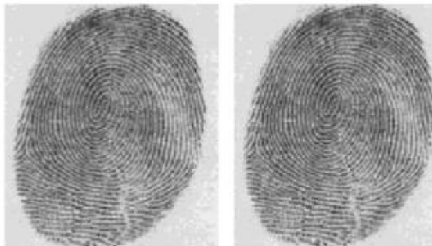
Рис. 15. Реконструкция (справа) отпечатка пальца (слева) после сжатия с помощью W -преобразования со степенью 26:1. Данные получены из Лос-Аламосской лаборатории США ( URL: ftp.c3.lanl.gov/pub/WSQ/print_data )
