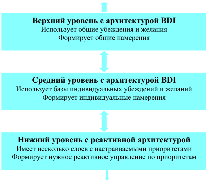
Рис. 8. Когнитивный агент гибридной архитектуры
