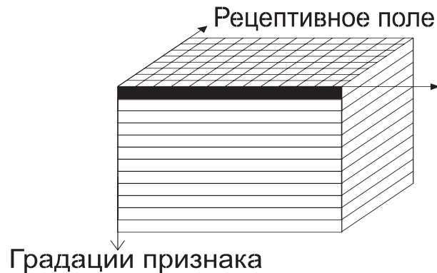
Рис. 3. Сеть с трехмерной структурой: двумерное топографическое отображение зрительного поля и одномерное представление градаций признака (ось, направленная вниз)
