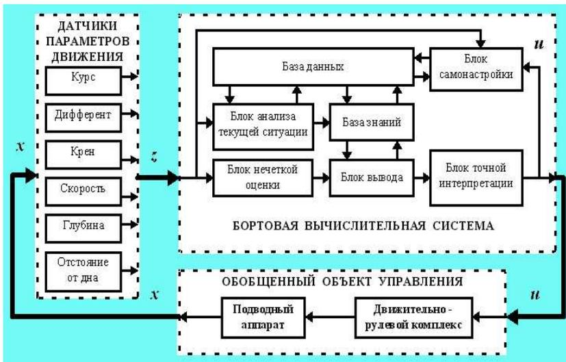
Рис. 3. Структурная схема интеллектуальной системы автоматического управления
